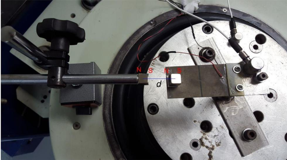
**Figura 25:** Vista superior com a indicação dos polos dos imãs (força magnética repulsiva).
