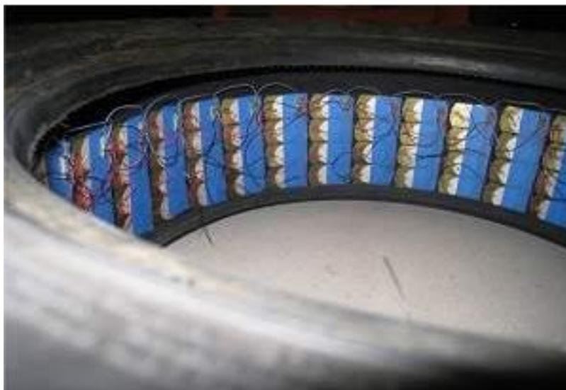
**Figura 3:** *Nanogeradores piezoeletricos dentro do pneu.*
