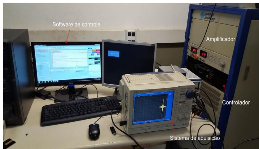
**Figura 20:** *Sistema de controle e aquisição de dados*
